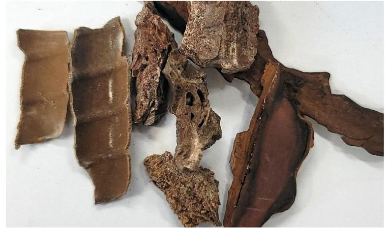
△ Samples :  $\text{Ca}^{++}$ ,  $\text{Mg}^{++}$ ,  $\text{Fe}_3\text{O}_4$ , 규소질 복합 scales
