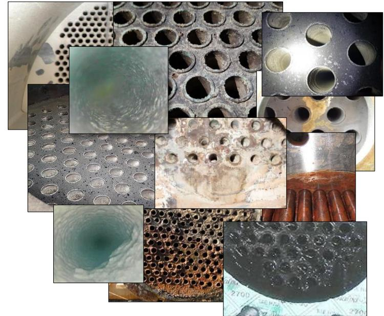
\*\* CIP Cleaning : 화학적 스케일 제거는 장비를 분해 할 필요가 없는 효과적인 현장 세정 솔루션입니다.=(On-line cleaning)
