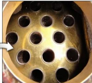
냉각수 tube side 내부의 미네랄 스케일의 세정 전, 후 모습
