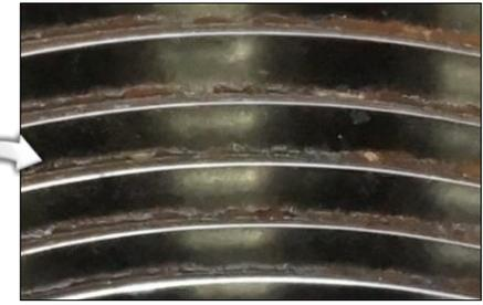
냉각수에 포함된 미네랄 스케일이 열전달 표면에 쌓여, 냉각 기능을 상실한 상태이며, 본 열교환기를 초기의 기능으로 회복시킨 세정 구현 결과입니다.
