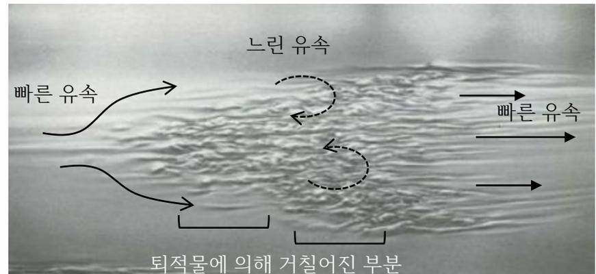
유체의 흐름(Top view) : 거칠어진 표면부위에서 난류(Turbulent flow)가 형성되어 느린 유속이 되며 부착물이 증식됨
