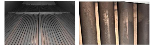
✓ Shell side의 튜브 외벽에 청수(냉각수) 스케일이 deposition 된 상태
