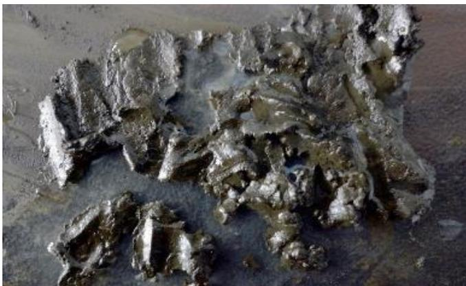
Oil sediment 의 경우 유기용제 또는 Flushing oil(Diesel ) + 유기용제 와 같은 유용성 솔벤트는 유기물의 용해는 가능하나, 무기물의 분해 및 용해는 불가능 합니다.
