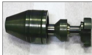
fuel injector , spindle guide 세정 전, 후
