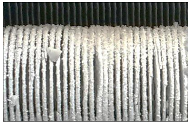
사용 불가능한 finned tubes
