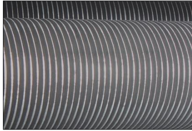
정상적인 finned tubes의 표면
