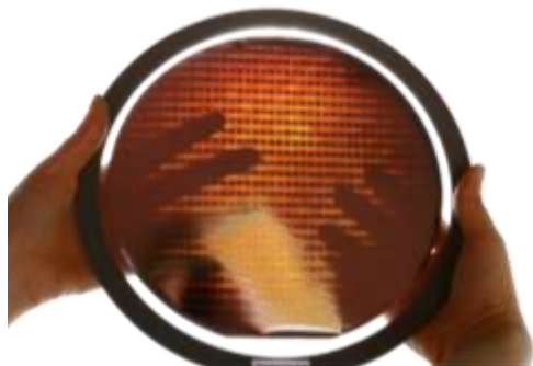
THK : 10 \mu\text{m} NAND flash memory wafer
