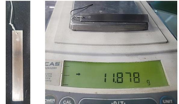
1. 세정 탱크에 테스트 시편 (coupon 형태)을 침적하여 일정 시간마다 정밀 전자저울로 중량을 측정한다.
