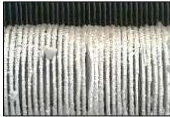
사용 불가능한 finned tubes
