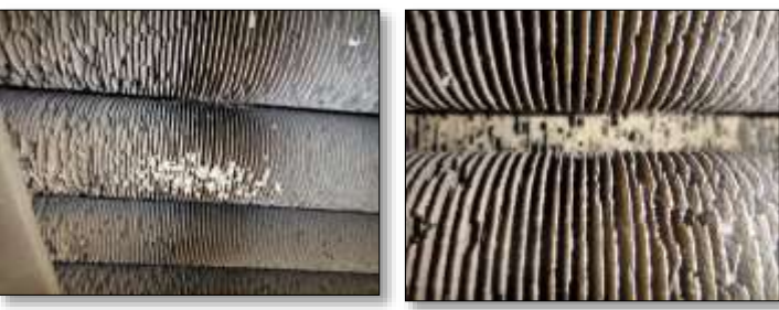
세정 관리가 미흡 하거나, 또는 부적합 세정제 (예를 들면, 가성소다 함유 세척제)를 사용했을 경우의 부식된 Finned Tubes의 부식 상태
