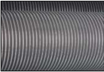
정상적인 finned tubes의 표면
