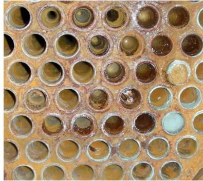
조수기( freshwater generator) 증발기의 해수 스케일(염석)
