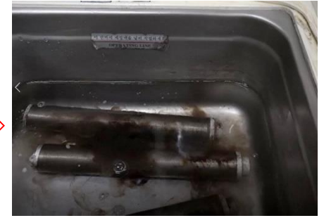
△ notch filter의 불려진 협잡물을 초음파 세정으로 제거 (약 10분)
