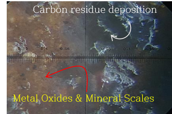
△ Sediments 현미경 사진 무, 유기물이 공존한 상태
