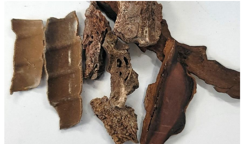
△ Samples : \text{Ca}^{++} , \text{Mg}^{++} , \text{Fe}_2\text{O}_3 , 규소질 복합 scales 암석과 같은 단단한 고형물
