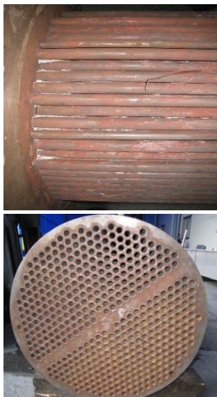
Shell side에 복합 화학 무기 물질로 fouling 된 상태
