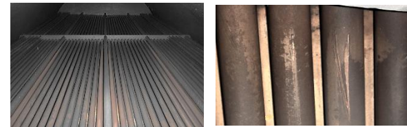
✓ Shell side의 튜브 외벽에 청수(냉각수) 스케일이 deposition 된 상태
