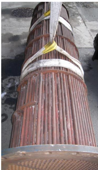
Shell side에 복합 화학 무기 물질로 fouling 된 상태
