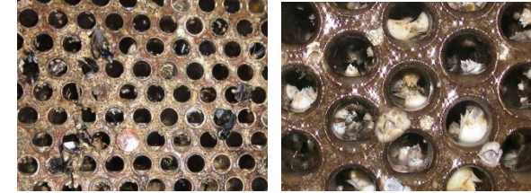
✓ Tube side 내부에 어패류 및 해수 스케일로 Fouling 된 상태
