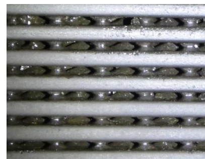
<그림 7> baffle에 의해구분되는 passage 구역별로 Fouling 상태가 상이함이 확인됨.
