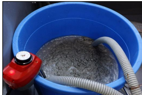
✓ 스케일이 용해되는 모습 Scale dissolved out
