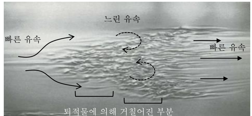
(그림 3) 유체의 흐름(Top view) : 거칠어진 표면부위에서 Turbulent flow 가 형성되어 느린 유속이 되며 부착물이 증식됨
