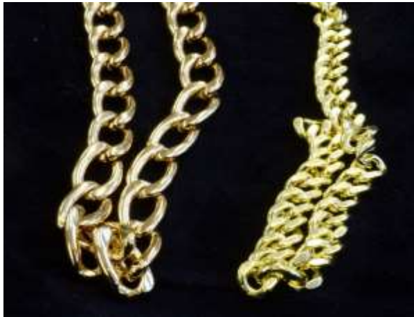
도금 후 레진 코팅 Vs Only chemical polishing
