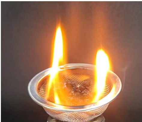
△ 증유 Sludge와 톱밥을 섞어 혼합한 고체 연료 부스러기에 불을 붙임
