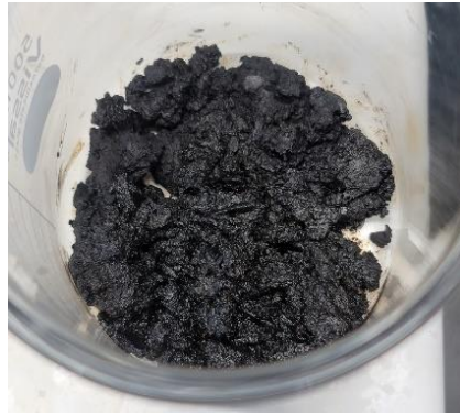
△ Bio- fuel tank의 고형 sludge ( 50g을 계량하여 Beaker 담음)
