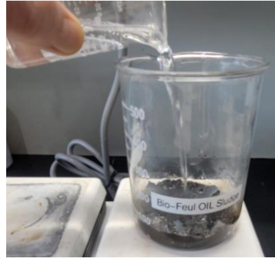
△ 50g의 sludge에 20%로 희석한 QuickClean-MK 50g을 첨가하여 2시간 동안 90°C 유지하여 용해 및 분산 시킴(교반 조작 없음)
