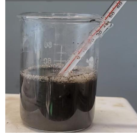
△ 10g의 sludge에 20%로 희석한 QuickClean-MK 40g을 첨가하여 5분 동안 80°C 유지하여 용해 및 분산 시킴( 마그네틱 교반봉으로 교반)
