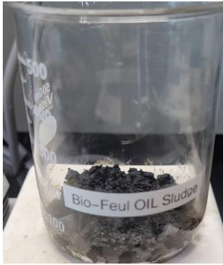
△ Bio- fuel tank의 고형 sludge ( 50g을 계량하여 Beaker 담음)
