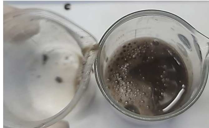
△ 용해되어 유화상태로 분산된 Sludge → CIP 방법으로 순환 세정 가능성이 확인됨
