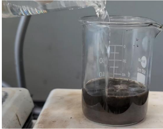
△ 10g의 sludge에 20%로 희석한 QuickClean-MK 40g을 첨가하여 5분 동안 80°C 유지하여 용해 및 분산 시킴( 마그네틱 교반봉으로 교반)
