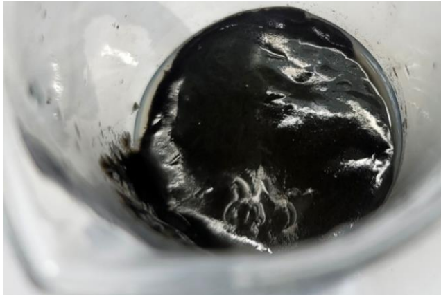
△ 1020 Shell side 열교환기의 sludge 10g을 계량하여 Beaker 담음
