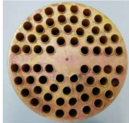
➤ Tube 내부 스케일이 완전히 제거된 모습
