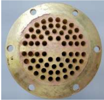
➤ Tube 내부 스케일이 완전히 제거된 모습
