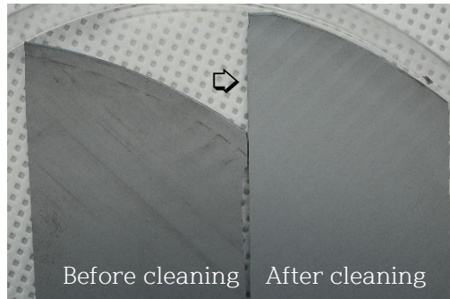
△ Sawed wafer cleaning 전, 후 외관 비교 (세정 후 bare 상태로 이물질이 완벽하게 제거됨)
